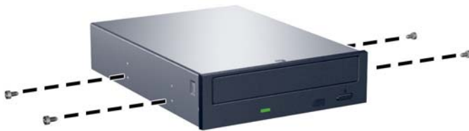
Figura 2-23 Instalação dos Parafusos-Guia (Mostrado Unidade Óptica)
