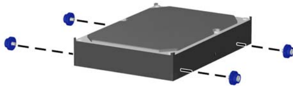
Figura 2-30 Instalação de parafusos-guia na unidade de disco rígido
